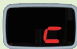
ポンプクリーニング
