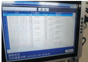
調理室:芯温測定確認パネル
