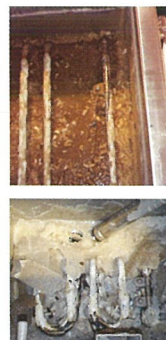
スケール付着したヒーター
